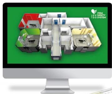
**Piattaforma software** che registra i dati rilevati dai sensori, le cariche microbiche e le attività di sanificazione, elaborando un indice di rischio per ogni ambiente, differenziato per colore.
