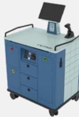
**FIDRUN**, interfacciabile con gli Health Information System, è dotato di monitor touch e cassette modulari configurabili ad accesso controllato e stampante termica per etichettare i preparati. **FIDRUN** identifica gli operatori tramite badge o impronta digitale, i farmaci attraverso barcode, i pazienti tramite braccialetti ed è in grado di ottimizzare la gestione logistica del farmaco in reparto.
